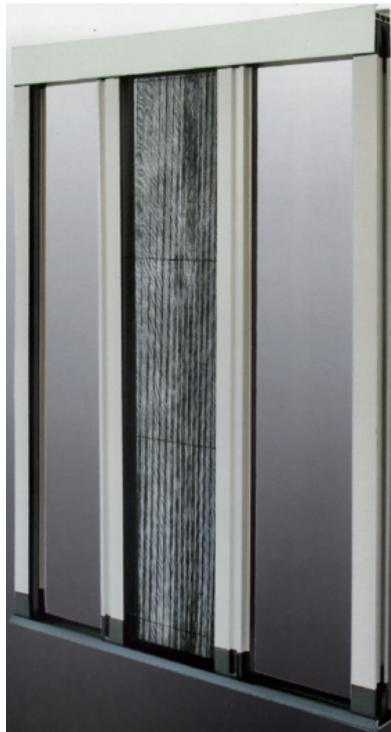
La Gioconda reversibile è una zanzariera per porte-finestre con rete plissettata a scorrimento laterale in entrambi i lati e comando frizionato. E' possibile fermare la barra maniglia in qualsiasi posizione facilitandone l'uso. E' consigliata utilizzarla in presenza di porte scorrevoli. La guida a pavimento calpestabile con profilo ribassato di 8 mm facilita le operazioni di transito.
